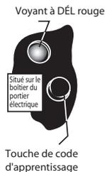
– Si le portier électrique ne comporte pas d'antenne, il s'agit d'un récepteur externe. Le couvercle du récepteur externe doit être enlevé pour avoir accès à la touche de code d'apprentissage et au voyant à DÉL.
